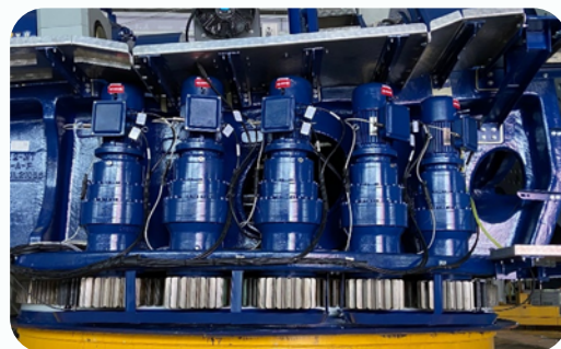
位於總裝廠的「新一代帶過載保護功能的偏航驅動」
