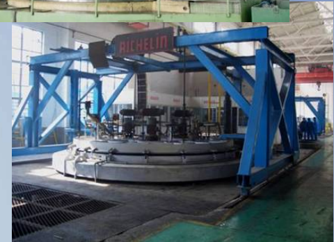
热处理渗碳炉
