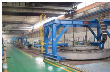
热处理渗碳炉
